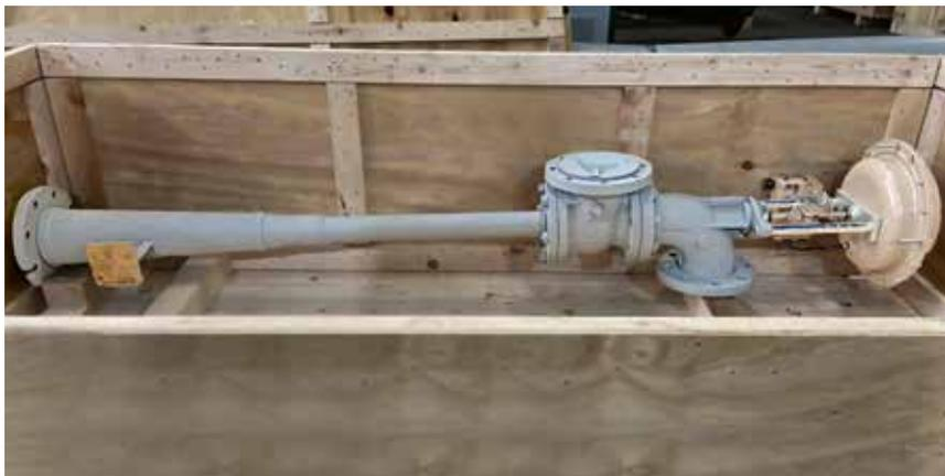
Kopf eines regelbaren Thermokompressors
