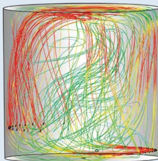
Numerisch simulierte Strömungs-verhältnisse einer Mischdüse
