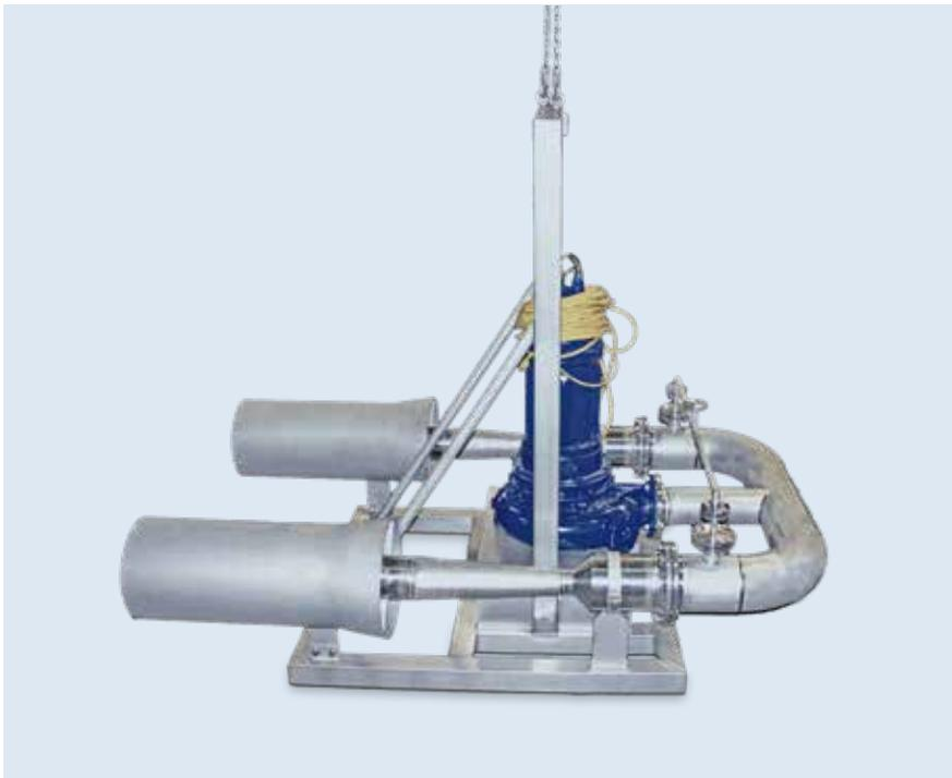
Mobiles Sauerstoffeintragssystem, das aus zwei Ejektoren und einer Tauchmotorpumpe auf einem gemeinsamen Grundrahmen besteht; bereit zum Absenken in eine Kläranlage.
